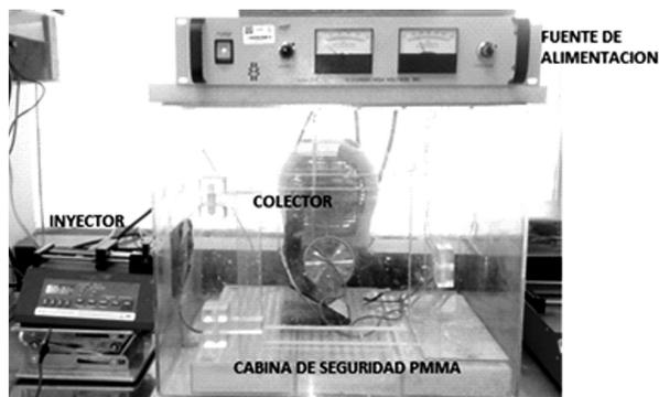
**Figura 1.** Proceso básico de electrohilado. Fuente Instituto de Investigaciones en Materiales UNAM
