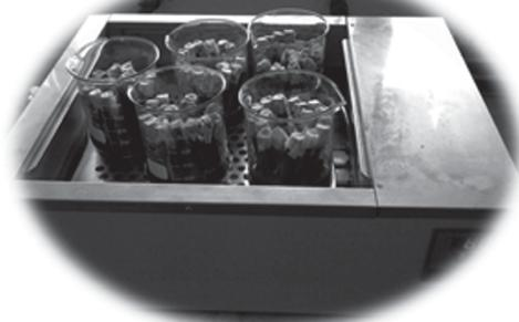
**Figura 4.** Incubadora con muestras e inóculo pepsina-celulasa (Digestibilidad enzimática)
