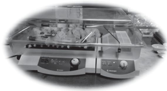
**Figura 2.** Incubadora con muestras en jeringas (Digestibilidad *in vitro*)
